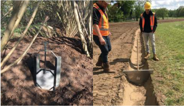
Handbediende afsluiter en een speciaal op maat gemaakt vloeimes, ook wel 'kroef' genoemd.
